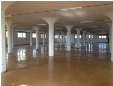
Beispiel Pilzstützen: Die Kräfte in der Decke werden durch die Pilze reduziert. Dementsprechend kann die Deckenstärke reduziert werden.
